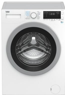
Beko HTV 8733 XS0. Type de chargement: Charge avant, Placement de l'appareil: Autoportante, Couleur du produit: Blanc. Capacité nominale (lavage et séchage): 5 kg, Vitesse d'essorage maximale: 1400 tr/min, Capacité nominale (lavage): 8 kg. Largeur: 600 mm, Hauteur: 840 mm, Poids: 68 kg. Classe de lavage: A, Classe d'efficacité énergétique (ancienne): A
